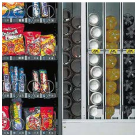
Schmal- und Standardschächte für die verschiedenen Getränkegebinde
